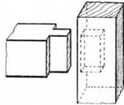
**Fig. 128.—Stub Tenon.**
