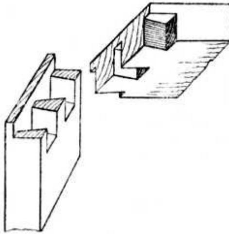
**Fig. 285.—Blind Lap-Dovetailing.**
