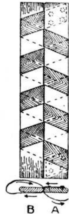
Fig. 244.— Draught Scr Tape Hinge.
