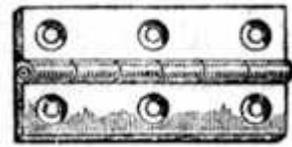
Fig. 222.—Butt Hinge.
